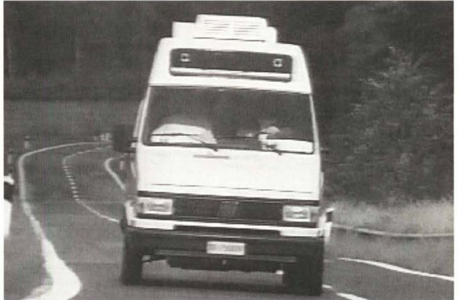
Ecco il MOBLAB. È stato adottato un furgone FIAT DUCATO Mod. 18 Maxi. Sul finestrone superiore sono alloggiate le due telecamere anteriori.
